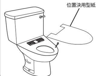
6: 本体の取り付けは、取付プレートが取り付けで来たら便器手前から本体をスライドさせ奥までまっすぐ差し込み取り付け完了です。
