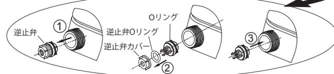
注意：水圧が0.1MPaの場合は必ずレギュレーターカバーとOリングは外さずにそのまま使用してください。
