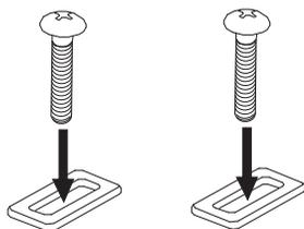
2. 先ほど作成した調整ワッシャを取付プレートに組付けます。
