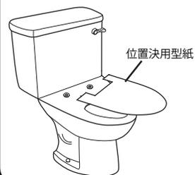
4: 図を参考に取付プレート便器に取り付けます。位置決用型紙を参考に前後の取付位置を決め便器を挟み込み下から便器をナットと固定板で挟み込むように下側からしめこみ固定します。
