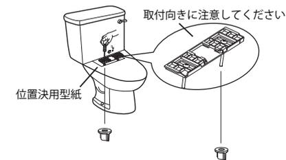
5: 取り付けテンプレートを取り外します
